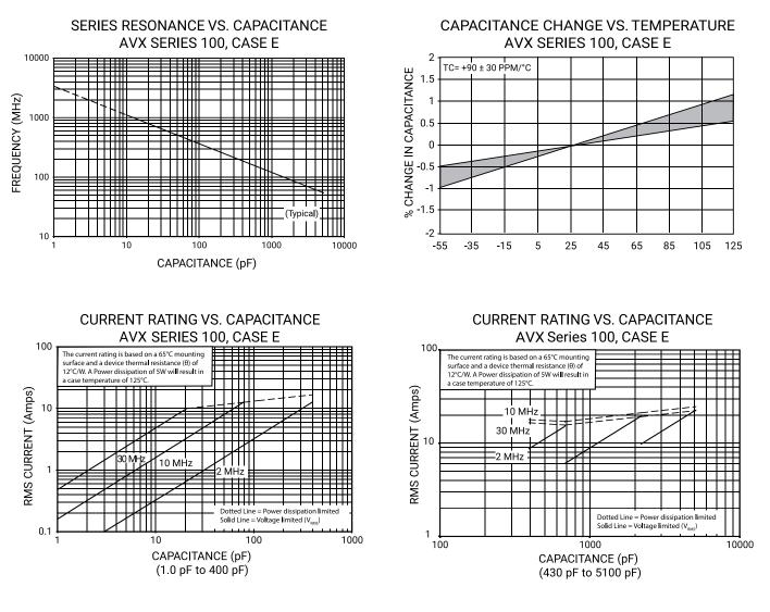
CURRENT RATING VS. CAPACITANCE AVX SERIES 100, CASE E, EXTENDED VOLTAGE
